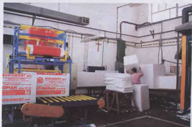
Linia do cięcia i pakowania płyt styropianowych
