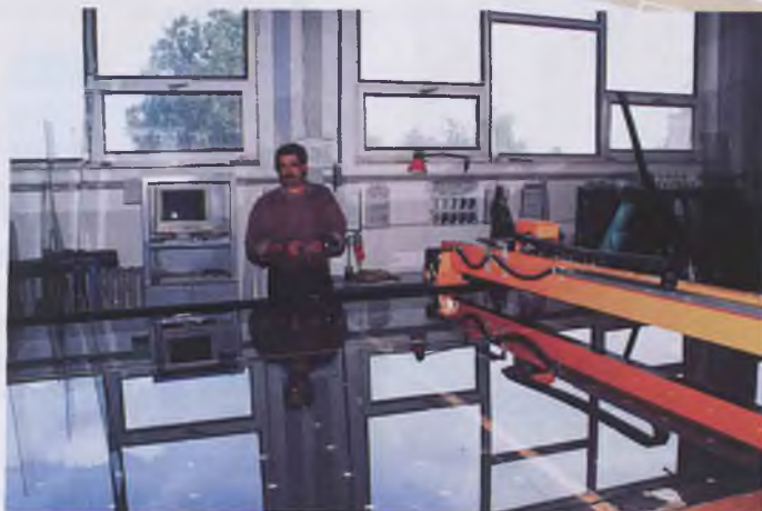
Urządzenie sterowane komputerowo umożliwia precyzyjne cięcie dużych tafli szklanych
